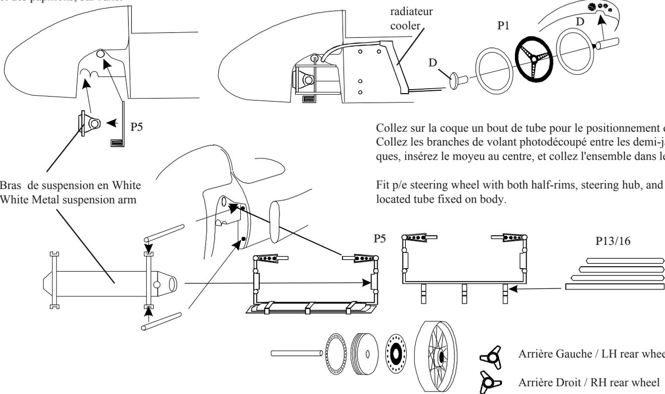
Collez sur la coque un bout de tube pour le positionnement du volant. Collez les branches de volant photodécoupé entre les demi-jantes plastiques, insérez le moyeu au centre, et collez l'ensemble dans le tube.
